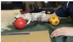
Une prothèse réalisée avec une imprimante 3D
