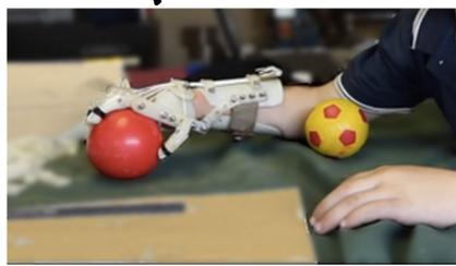
Une prothèse réalisée avec une imprimante 3D
